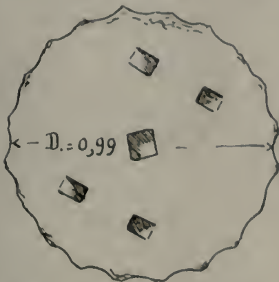
Fig. 150. — Lit supérieur d'un tambour de colonne archaïque.
