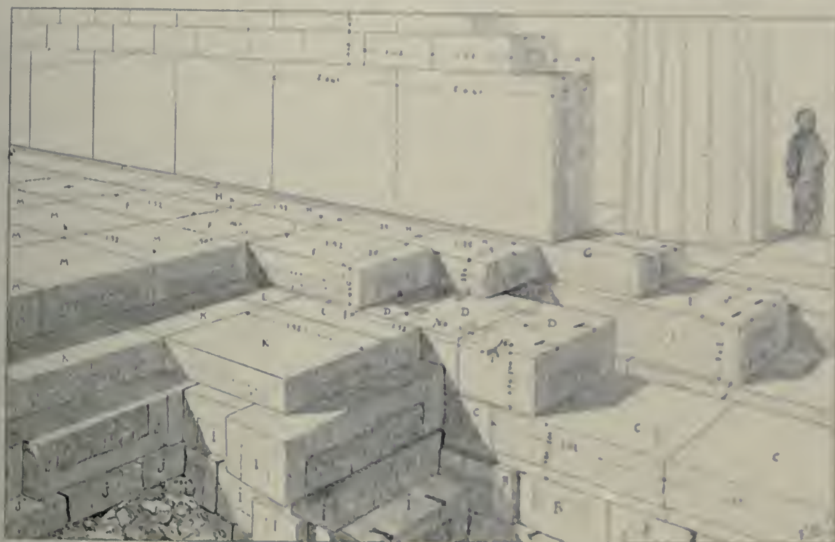
Fig. 42. — Vue perspective montrant le mode d'appareillage des soubassements du stylobate et sur le côté de la cella.
