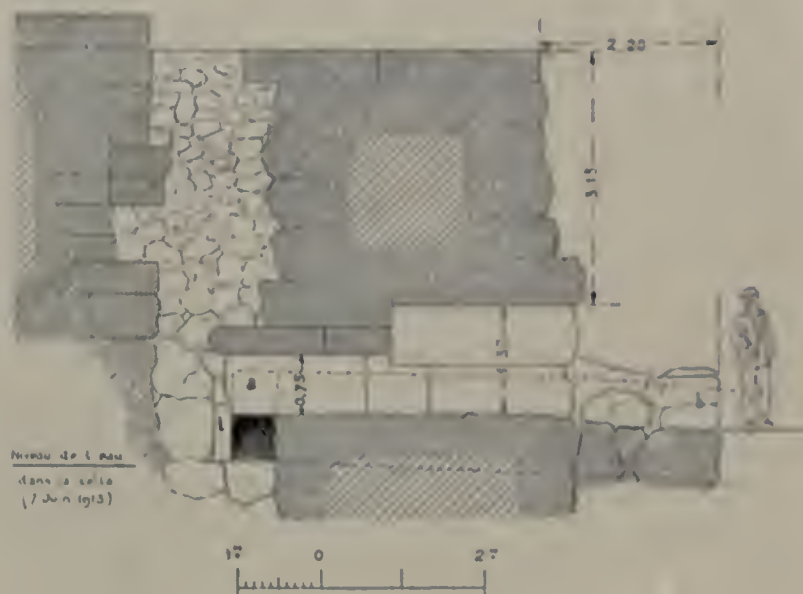
Fig. 134 — Coupe sur l'aqueduc a b.
